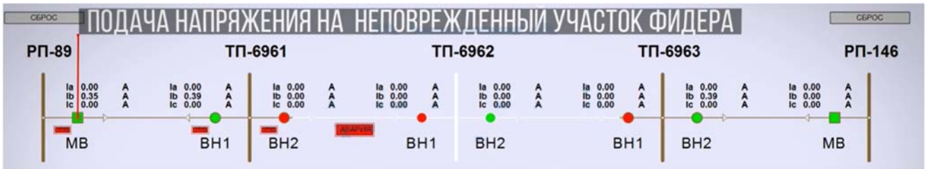
Рис. 3 – Возобновление электроснабжения неповрежденного участка
