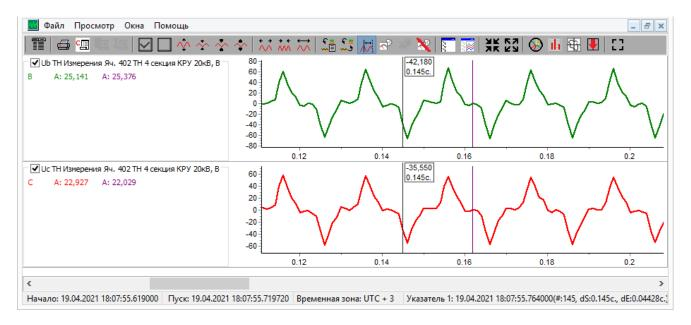
Слева от каждого графика расположена область легенды, в заголовке которой отображается название канала из СFG-файла осциллограмм и через запятую единица изменения (если указана). Ниже в панели легенды расположен идентификатор фазы, к которой относится данный канал и значения в точках под основным (синим) курсором (в цвет канала) и под дополнительным (фиолетовым) курсором (фиолетовым цвета).
