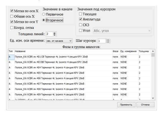
Переключатель «Первичное»/«Вторичное» позволяет переключить отображение токов/напряжений в первичной или вторичной обмотке трансформатора. Эта настройка отображается только в случае, если версия стандарта поддерживает данные значения.
