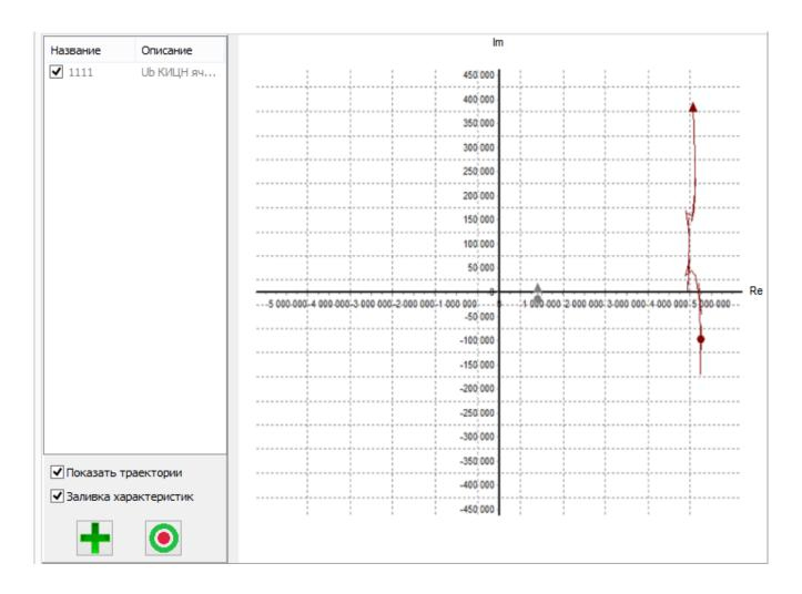
В левой части окна располагается список добавленных сопротивлений. В графе описание отображается расчетная формула. Цвет строчки соответствует цвету точек на диаграмме. Снятие флага «Показать траекторию» позволяет скрыть кривую годографа с графика (останутся видны только маркеры начальной и конечной точек), если она слишком «затеняет» комплексную плоскость. Флаг «Заливка характеристик» —
