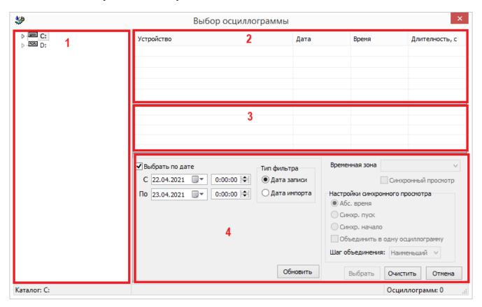
В левой части диалога находится дерево выбора каталога с файлами нарушений (область 1). При проходе пользователем по дереву каталогов программа выбирает все файлы с расширением CFG (или zip-архивы, содержащие файл с расширением CFG). При нахождении в текущем каталоге файлов конфигурации осциллограммы в формате COMTRADE, информация о нарушении (имя прибора, время нарушения и его длительность) отображаются в правой части диалога (область 2).
